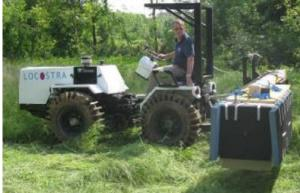
Figure 5. TeODOR - VALLON Metal Detector Array
